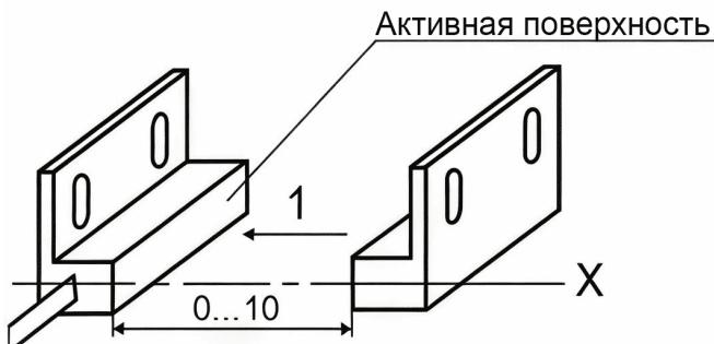
При нахождении датчика в зоне действия магнитного поля инициатора контакты геркона замыкаются и остаются в замкнутом состоянии до тех пор, пока инициатор не выйдет из чувствительной зоны датчика.
